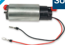
BOMBA DE COMBUSTÍVEL GASOLINA UNIVERSAL 12V 3.0 BAR 85L/H 8.5A
